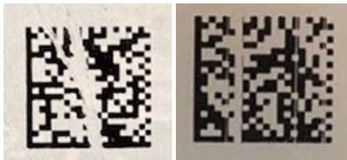
Нарушение целостности КМ*
